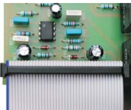
Anschluß des Flachbandkabels auf dem Bedienteil
