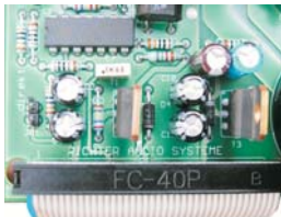
Anschluß des Flachbandkabels auf der Hauptplatine
