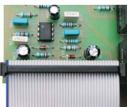
Anschluß des Flachbandkabels auf dem Bedienteil
