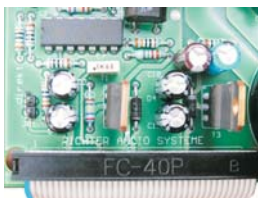
Anschluß des Flachbandkabels auf der Hauptplatine
